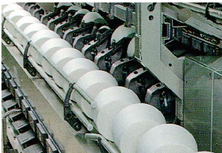
具有光滑表面的输送带, 用于纱线滚装运输。
