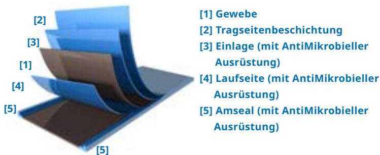
Die neuen Bänder bestehen aus mehreren Schichten (siehe Skizze), deren abschließende Tragseitenbeschichtung unbehandelt ist. Diese Schicht besteht entweder aus Nonex oder Ropanyl – bewährten und hochwertigen Produkten, die mit modernsten Produktionsverfahren hergestellt werden. Dadurch ergibt sich eine nicht-poröse Oberfläche mit außergewöhnlichen Reinigungseigenschaften.
