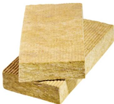
La lana di roccia è usata per l'isolamento termico e acustico. È ottenuta da fibre composte da pietre di basalto e dolomite riscaldate a temperature fino a 1650 °C.
